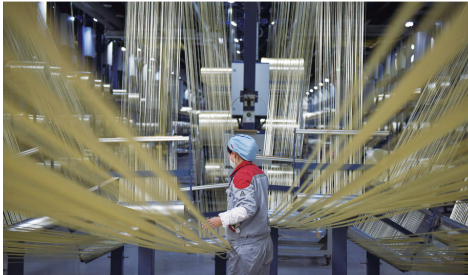
▲在中复神鹰碳纤维西宁有限公司,工作人员在整理碳纤维原丝。
