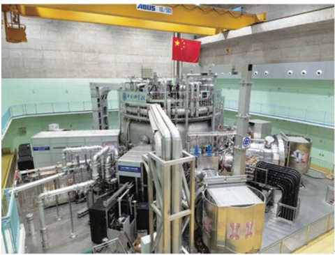
中科院合肥物质科学研究院等离子体物理研究所所有“人造太阳”之称的全超导托卡马克核聚变实验装置(EAST)。
