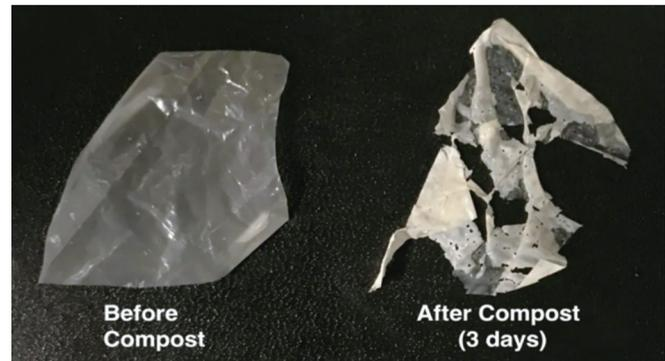
据《中国科学报》报道,目前的生物可降解塑料在降解过程中可能污染其他可回收塑料,并且降解后产生的微塑料颗粒仍然具有环境危害性。近日,来自美国加州大学伯克利分校的研究团队设计了一种酶激活的可堆肥塑料。这种塑料的设计思路是运用一种四分子随机共聚物,将蛋白酶和脂肪酶运用纳米分散技术置于传统的生物可降解结构中,例如聚乳酸和聚己内酯。
