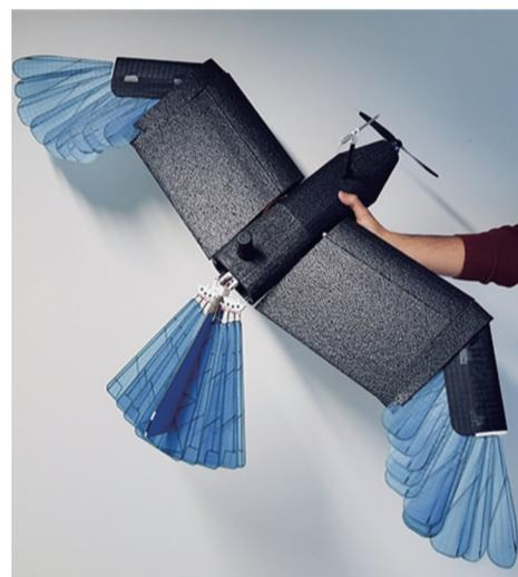
据《人民日报》报道,瑞士科学家近日展示了一个可以像鸟一样的有翼无人机,在密集的城市和森林环境中急转弯避障。这个无人机由纤维强化塑料制成,最大翼展1.5米,重711克。它有两个机翼、一个尾部,类似于鸟的外观,拥有人造羽毛,可以收拢和倾侧。
