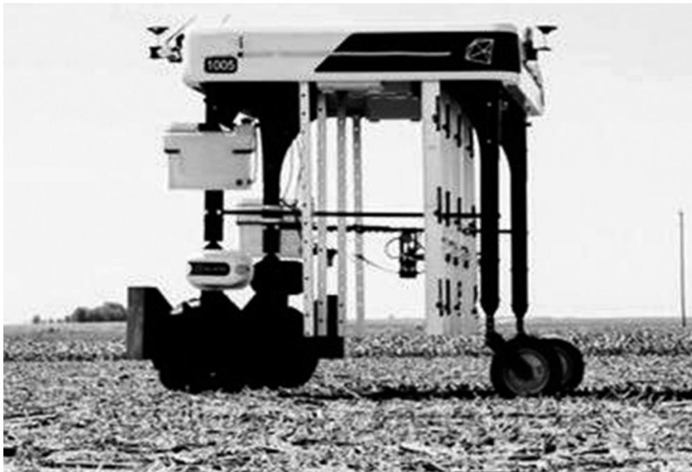
这款机器人负责检查和报告农作物但不喷洒农作物,它由四个机载太阳能电池板供电。当它自主地在种植田里来回走动时,会利用一套集成传感器对它经过的每棵植物进行“从根到叶”的扫描。如果系统确定该植物是杂草就会有选择地对其使用除草剂。
