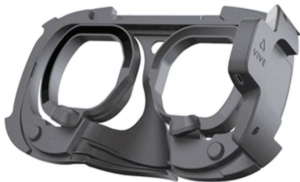
这款VR面部系统具有60Hz的追踪率,并能“以最小的延迟使嘴唇与声音同步”——该系统的响应时间低于10毫秒。该设备可插入耳机的USB-C接口,重量约为11.6克,所以它应该不会给你的脑袋带来负担。其眼部追踪器有一个双摄像头系统,可以捕捉到目光的方向和来源,眨眼以及你的瞳孔大小和位置。
