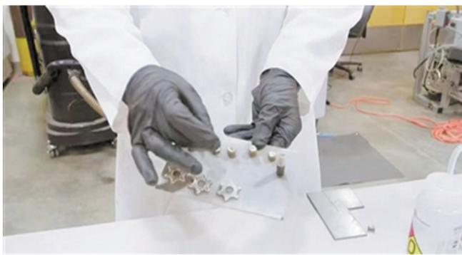
据《环球时报》报道,近日,美国华盛顿州立大学的研究人员发现,将少量模拟碎火星岩石与钛合金混合,在3D打印过程中制成一种更坚固、更高性能的材料,可用于制造探索这颗红色星球的工具和火箭部件。这一突破可以使未来的太空旅行更便宜、更实用。
