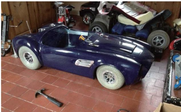
据新华社报道，美国一位聪明的爸爸给儿子造了一辆“眼镜蛇”牌迷你汽车，这辆车是由电动滑板车和玻璃纤维外壳制成的。现在，两人正家中进行第二个项目——迷你路虎。
