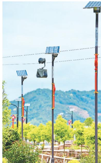
智慧物流运输快线是在低空架设钢索且由云端系统控制穿梭机器人在索道上运输货物的新型智能化、轻量化、无人化运输系统。
