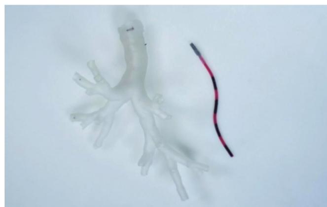
据新华社报道，英国利兹大学“风暴”实验室团队近日开发了一种“磁性触手机器人”，直径只有2毫米，大约是圆珠笔笔尖的两倍，可由患者体外的磁铁引导进入肺部狭窄的管道。研究证明，这种机器人可以到达肺部最小的支气管处，可采集组织样本或提供癌症治疗。
