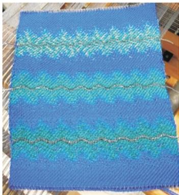
设计需要将一种特殊的电织物——压电纤维编织到织物纱线中,能将可听见频率的压力波转换为机械振动。这种纤维能将机械振动再转化为电信号,类似于耳蜗的作用。只需少量这种特殊压电纤维就能让织物具备声音灵敏性:一根纤维就能制作几十平方米的纤维麦克风。
