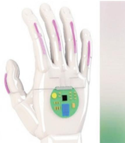
这种手套能将手语实时翻译为语音,它的五根手指上置入了传感器,使其能够随着手型的变换识别出美国手语中的单词、短语或者字母。然后将识别出的信号以无线方式传输到手机上,并通过手机以每秒一个单词的速度翻译成口语。 张佳
