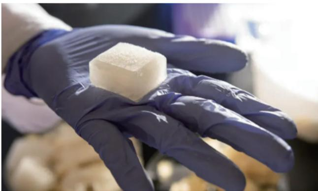
据《环球时报》报道,科学家们正在着手解决冰块融化后再也无法使用这一局限性,采用可重复使用的水基“果冻冰块”。近日,这种冰块由加利福尼亚大学的一个团队开发,由一种水凝胶制成,其中包括10%的蛋白质衍生明胶和90%的水,形似果冻。这种材料可以被切割成任何需要的大小或形状。它在室温下是透明和抖动的,但一旦冷冻就会变得坚硬和不透明。
