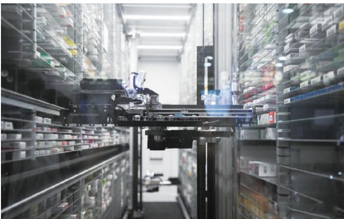
近日,湖南省长沙市第一医院门诊智慧药房正式投入使用。据介绍,智慧药房引进药品自动存储发放管理系统,药方经药师审核后,系统开始自动配药,药品由机械臂取出,并通过传输通道送到取药窗口,提高了药品配发的效率与准确率,缩短了患者取药等候时间。同时,智慧药房还配备麻醉药品智能化管理系统等,进一步促进药品安全和药事管理效率的全面提升。图为在长沙市第一医院门诊智慧药房,机械臂将药品取出。 薛宇舫 摄
