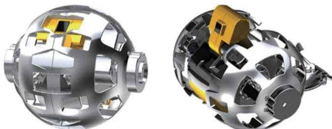
据《科技日报》报道,日本宇宙航空研究开发机构称,它们计划于2022年将一款小型变形机器人发射至月球。该机器人外观为一个直径80毫米、重250克的球体,可以节省着陆舱的空间。根据计划,机器人在抵达月表后,机器人将从中间对半分,由一个中心轴连接两个半球型的车轮,更方便在月球表面移动。 图片来源:JAXA
