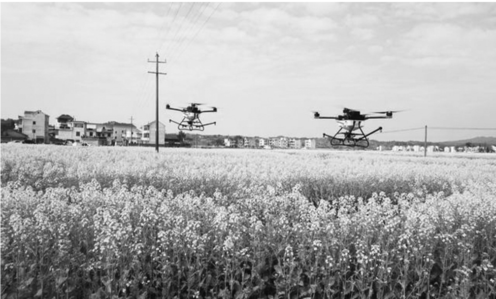
日前,山地油菜绿色高质高效全程机械化生产现场观摩培训会在江西婺源召开。此次会议从播种、开沟、施肥、割晒、捡拾脱粒、联合收获等环节全面展示了我国山地油菜的机械化生产技术。图为展示的无人机飞播技术。
