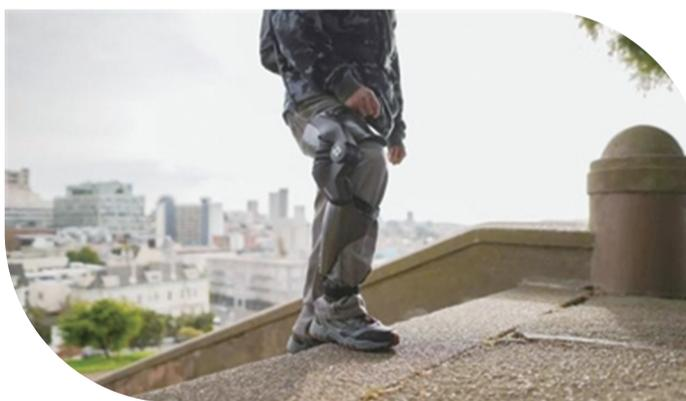
这款产品利用人工智能进行适应性技术,感知佩戴者的运动并进行相应的调整。该产品普遍采用嵌入式传感器,可以检测上下楼梯和从坐姿站起来等动作。它利用电源和空气压缩机来创造特定的动作,以协助实现辅助人体运动。 于兆云
