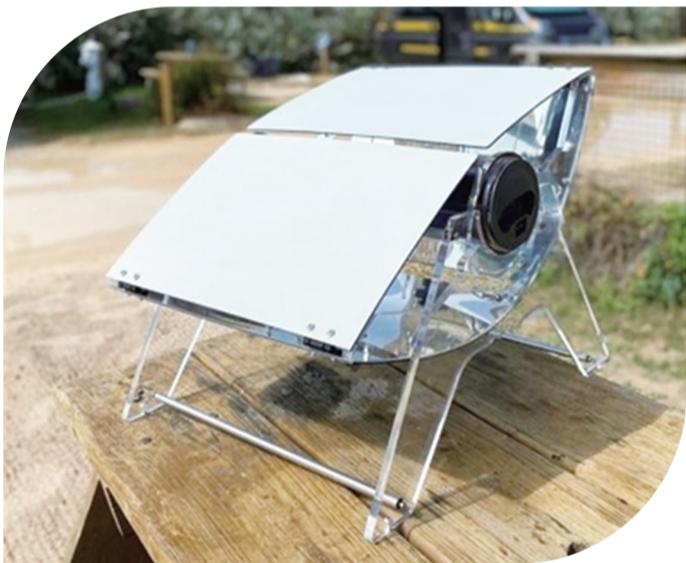
这款太阳能烤箱配备两块抛物线外形的发光板,能够收集太阳光并聚焦于一根绝缘的真空管上,热量可以把食物煮熟。对于一个五口之家,太阳能烤箱能够满足30分钟内的就餐需求。即使阴天或夜间,亦可利用内置的加热元件(可连接至2V电源)来达到预设温度。 张雪峰
