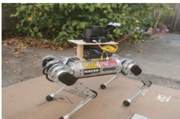
据《科技日报》报道,近日,美国加州大学开发出了一种装备柔性牵引带的电子导盲犬。该电子导盲犬能够根据环境调整自己的速度与方向,并控制牵引带的松紧。在较狭窄的环境中,导盲犬会先探索周围环境,并使牵引带处于松弛状态,避免误导使用者。 图片来源:Hybrid Robotics Group, UC Berkeley
