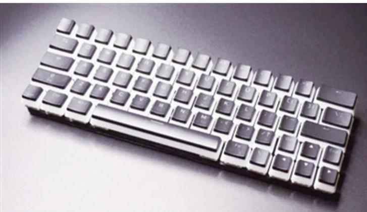
这款键盘采用普通的QWERTY布局,使用双色键帽,看起来与常规键盘无异。该键盘支持以“和弦”的方式进行输入,同时按下两个按键即可一次性键入单词,如同弹钢琴一样。这种键盘能够实现每分钟250个英文单词的输入速度。 艾云飞
