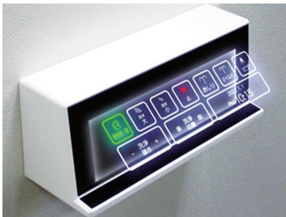
这款全息键盘利用“浮空成像”技术,该键盘集成了光学元件,能够在键盘上方的空气中投出高清影像。基于该键盘空间传感技术的独特算法,能够实现在手指在浮空影像中自由操作,并且响应也十分灵敏。张雪清
