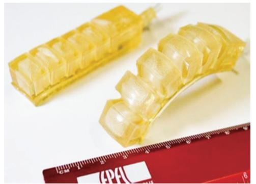
这种“可食用”机器人使用的是基于食用级材料明胶的通用生物凝胶。它不仅可被人吃,还能在几个小时内被污水中的微生物吃(分)掉(解)。据悉,这种材料弹性很强,可自我粘附、快速愈合、易于复制和缩放,能在处理时完全降解。
