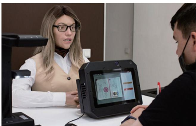
据《科技日报》报道,俄罗斯最大的自动服务机器人制造商Promobot为人形机器人研制出了“活生生”的眼睛、柔软的皮肤和头发,使得人形机器人拥有了逼真的外观,可以假乱真。研究人员称,研究人形机器人的一项主要任务是创建一个界面,人们可以通过该界面在情绪、情商层面与机器人进行沟通,以便其识别面部及表情。
