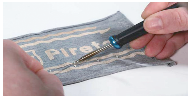
Pireta公司开发的自由形态工艺,允许电子系统在各种织物上组装和互连,从而实现真正的智能服装和电子纺织品。图片来源:cinno
