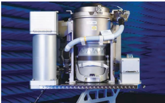
据环球网报道,今年,美国宇航局的的研究人员采用耐腐蚀材料来制作太空马桶,一部分部件还是3D打印的产品。此次研发的太空厕所,比之前的厕所更加舒适,更加可靠,质量和体积也更小,差不多是原来的一半。
