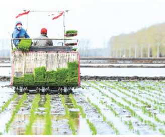
在黑龙江省农垦红兴隆管理局友谊农场的一块水田里,采用北斗导航定位系统的智能导航无人驾驶水稻插秧机正在插秧。 刘帅冶摄
