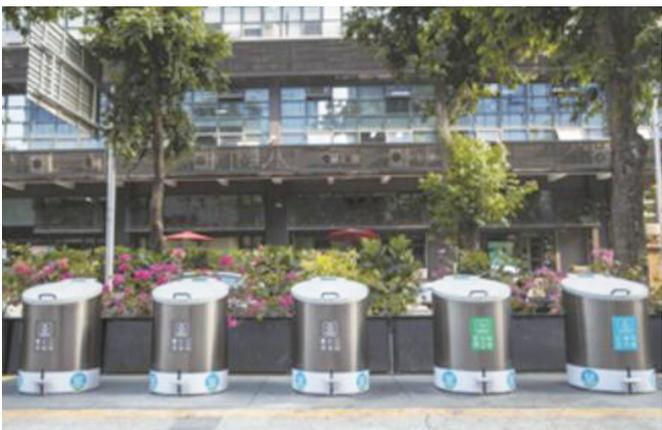
一批具有消毒防疫功能的地理式垃圾桶日前在深圳启用。据介绍,地理式垃圾桶的收集桶位于地面以下,清运时才露出地面,桶内垃圾满溢可自动报警,通知环卫人员清运。此外,该类地理式垃圾桶还配备排水系统与灭火系统,并可在地下密闭空间进行自动消毒。图为深圳市福田区地理式垃圾桶。 卢焯 摄
