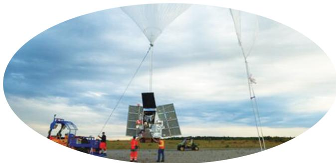
没有什么仪器比美国宇航局耗资50亿美元的哈勃太空望远镜更能揭示太空的奥秘了,但一些研究人员认为,只要花费200万美元,用气球将望远镜吊到太空边缘,它就能实现哈勃望远镜的某些功能。近日,研究团队在一次飞行中,超高压气球承载成像望远镜展现了保持稳定能力,以及接近哈勃望远镜分辨率的为遥远恒星精细成像的能力。
