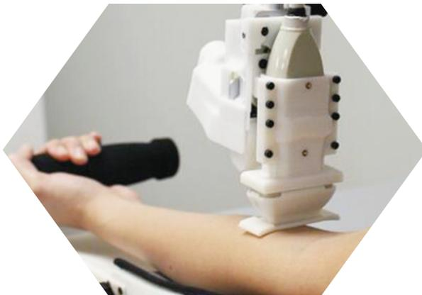
一支来自VascuLogic公司的研究团队,研发出世界上第一台自动静脉穿刺医疗仪,可自动完成静脉采血过程,应用于血液抽取,或静脉注射管的放置。
