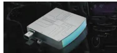
这款车载激光雷达高度仅有24mm,比1元硬币的直径还要小1mm,更小的机身厚度可以更好地满足车身结构和造型的需求,同时也减小了激光雷达对整车风阻的影响。它具有最远300米的测程,在10%的标准漫反射面被测物也可以实现200米的测距,探测概率可达90%以上。整个视场范围内采用重复扫描的方式,没有重叠的视场区域。
