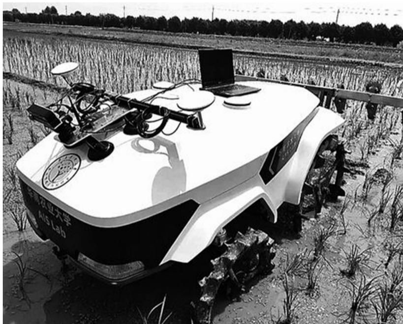
近日,华南农业大学水利与土木工程学院院长齐龙团队聚焦纯电动底盘的技术难点,以电动化和智能化为核心,成功研制出纯电动水田智能底盘,同时搭载智能导航和视觉识别系统,能自动识别作业区域实现厘米级精准作业。与传统农机相比,新能源农机的优势主要体现在环保性、经济性和智能化三个方面:一是以纯电动为代表的的新能源农机完全避免了尾气排放,真正实现零污染;二是纯电动农机的能量利用效率较高,能源费用显著低于传统燃油农机,同时由于零部件减少,维护保养成本也相对较低;三是纯电动农机可配备先进的智能控制系统,能够实现精准作业、远程操作和数据监控,大幅提高农业生产效率。
