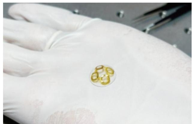
这款具有眼动追踪功能的隐形眼镜所用的医疗级硅橡胶材料厚100微米左右,其上均匀分布着4个金色线圈。4个线圈是射频器件,也是感知眼球运动的关键。如果眼球在运动,隐形眼镜反射回来的信号频率和强度就会发生变化。通过分析信息数据,就能了解眼球运动的轨迹。
