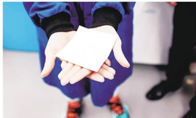
这种新型可穿戴织物,利用了辐射制冷原理。它分三层:内层由羊毛或棉等常见服装面料制成;中层由银纳米线制成,能反射大部分阳光辐射;外层是由一种名为聚甲基戊烯的塑料材料制成,这种材料对大多数波长既不吸收也不反射,但会发射一小段红外辐射。
