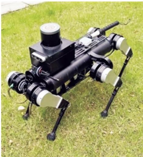
据《武汉科技报》报道,这款导盲机器人具备先进的视觉环境感知功能,能够自主导航至目的地,动态躲避障碍,甚至能识别红绿灯。该机器人能够根据盲人的语音指令快速响应,目前语音识别准确率高达90%以上,通过语音交互,可以实时反馈行走和环境状况等信息,实现双向智能交互。
