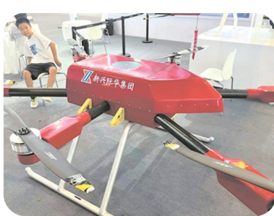
超大载荷空地协同系留无人机。
