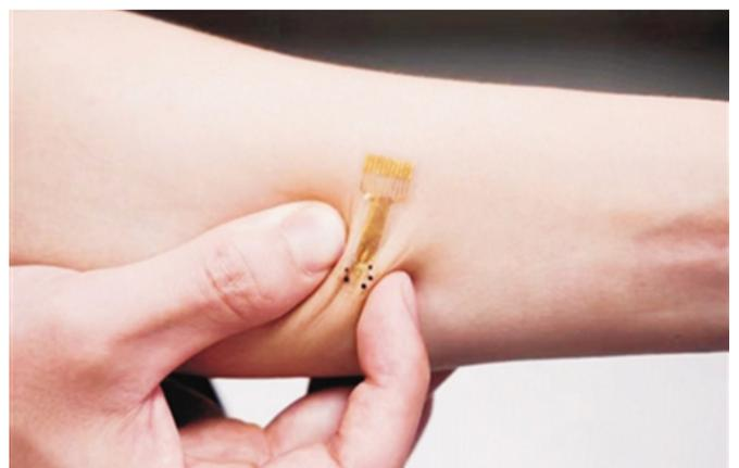
这款可自动感知伤口内部变化并作出反应的“智能绷带”可实时提供药物及其他治疗。智能绷带采用多种尖端材料制成,包括生物电子材料,可向组织和细胞传递电刺激来帮助愈合。它在收集到数据后,可立刻使用机器学习工具进行分析和处理,医生即使在远程也能进行快速有效的监测和护理。
