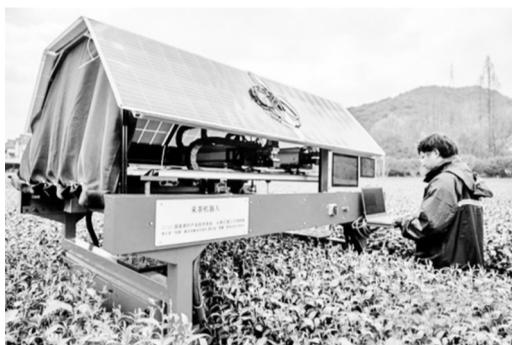
浙江理工大学农业机器人与装备创新团队研发的智能采茶机器人,可以实现自主识别茶树芽叶进行采摘。
