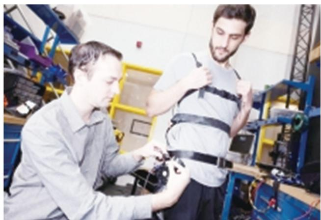
这款控制机器人外骨骼,无需专门训练、特别校准,对复杂算法进行调整后,用户穿上外骨骼就可以直接行走。新系统使用深度学习自动调整外骨骼为人类提供帮助的方式,现已证明这种外骨骼可顺滑地支持行走、站立以及爬楼梯或坡道等动作。
