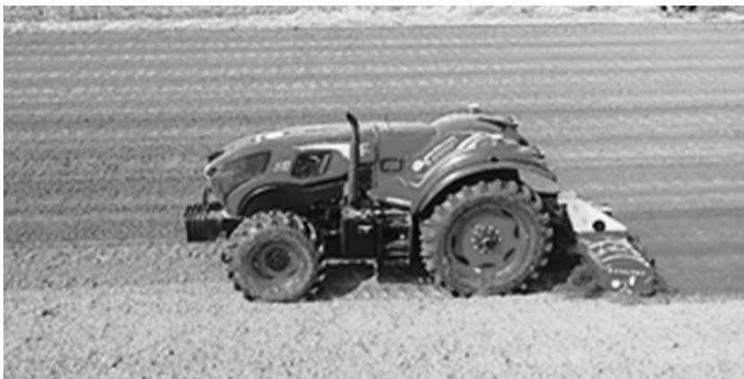
北京市农林科学院信息技术研究中心研究员吴华瑞介绍,拥有高度发达“大脑”的无人拖拉机,结合北斗定位和惯性导航系统,可实现路径自主规划、远程启动、出库、田间作业、自动避障、入库等全流程作业。图为国内首个出口蔬菜全程无人智慧农场日前在山东省莱阳市开工。
