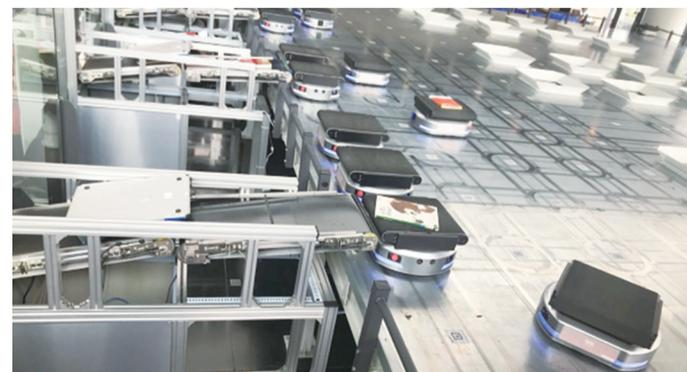
广东省深圳市宝安区图书馆采用“慧还书”系统,将智能机器人应用于图书分拣工作中。系统包括“小智”分拣机器人和“若愚”搬运机器人,两种机器人同时开工,集中处理所有归还图书。
