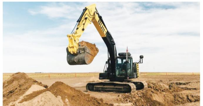
如今,无人驾驶已经不是什么新鲜事,就连挖掘机也开始“玩”起了无人驾驶。建筑施工现场呈现一派新场景:操作人员把数据输入无人挖掘机后,无人挖掘机就能结合3D环境建模和高清定位,对场景及任务进行全局分析,高效智能地执行自主避障行走、自动装车卸车、回退挖沟等既定施工任务。此外,无人挖掘机还能实时测量已挖沟槽的尺寸,施工精度可达厘米级。
