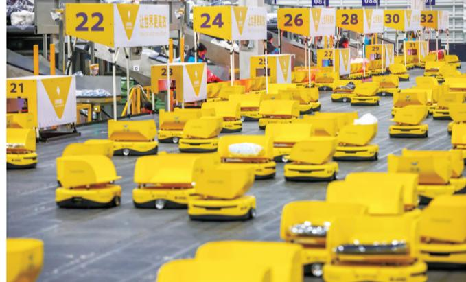
随着数字化、智能化浪潮的推进,机器人被运用到各行各业。近日,在浙江省湖州市德清县乾元镇第一产业智慧物流园区某物流中心,880台分拣“小黄人”机器人来回穿梭,精准快速地配送各类服饰,提升了配送工作效率。
