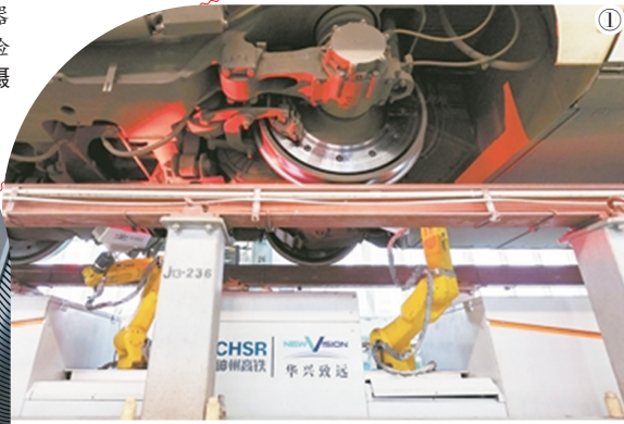
图①为动车组检修机器人在上海虹桥动车运用所检查动车组车底 王翔 摄
