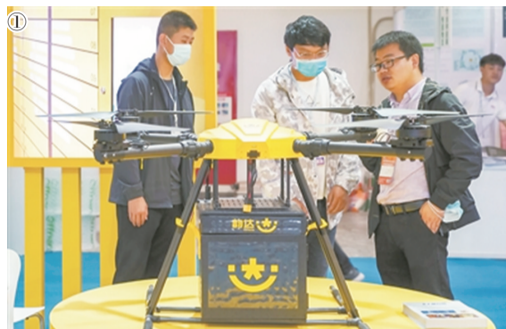
图① X4多旋翼无人机。该无人机航时约半小时,最大载重7千克,可被用于偏远山区等交通不便利区域。
