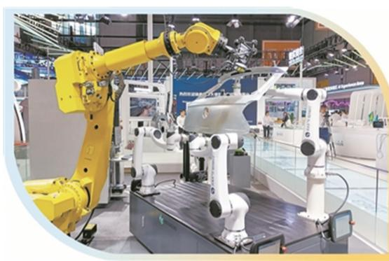
海克斯康展台的柔性夹具系统正在对一块汽车车门进行检测
