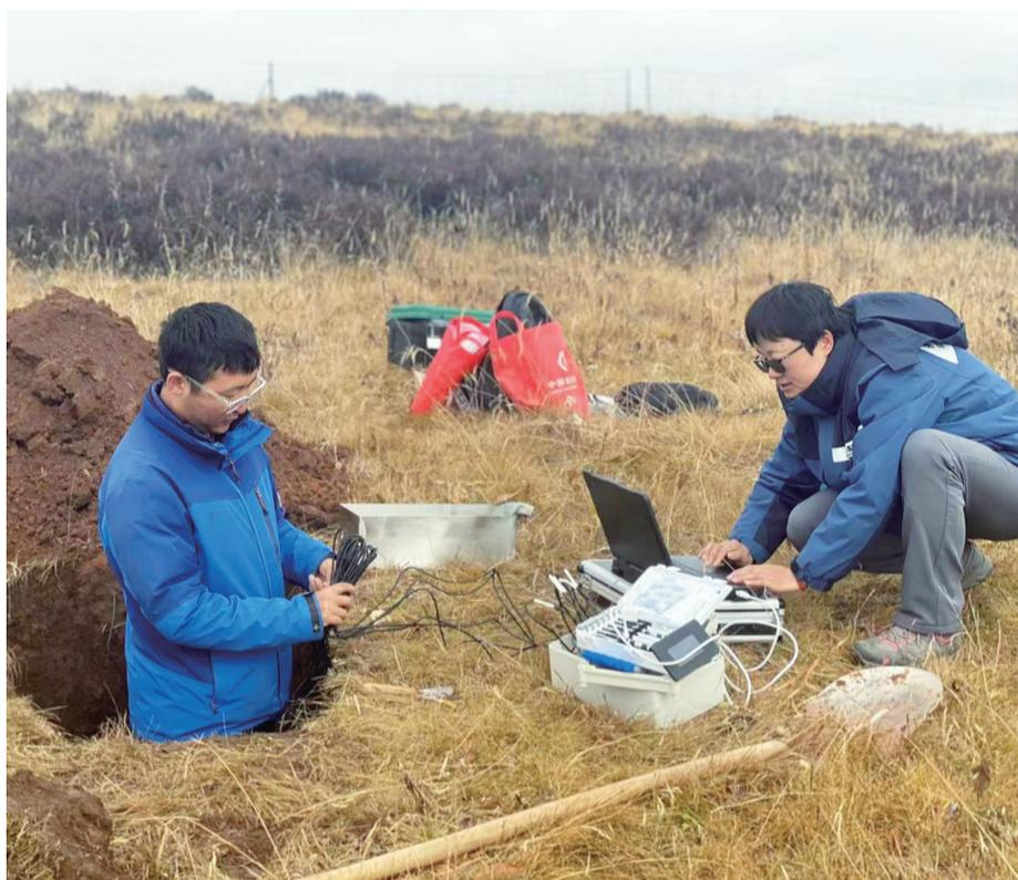
近日,由青海省气象科学研究所与黄南藏族自治州河南县气象局联合开展的小网格土壤水分遥感地面校验场在河南县建设完成,标志我省首个多尺度嵌套的土壤水分遥感地面校验场“落地”。目前,在河南县境内建设的观测站点共计48个,其中大网格31个、中网格9个、小网格8个,可以满足不同分辨率卫星数据的校验需求,为省内防灾减灾提供数据支撑。图为技术人员在建设小网格土壤水分站点。
