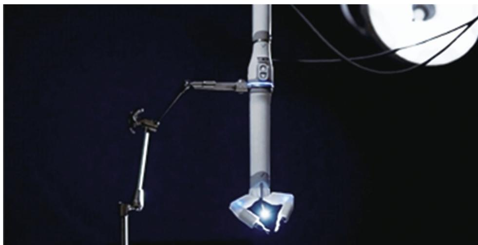
这款机器人,重量约为0.9千克,呈纤长的圆柱体,底部有两根可以移动的操作手臂,末端配有抓取和切割的工具。
