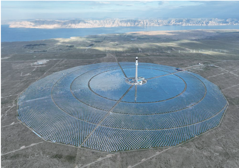
图为海南藏族自治州共和县的塔式光热发电项目
