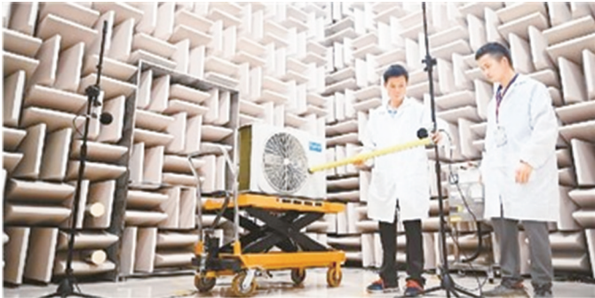
柳州市柳江区大力发展智能家电产业,目前已经引进智能家电企业29家。图为技术人员在柳江区一家空调企业的实验室里对即将上市的产品开展噪音测试。
