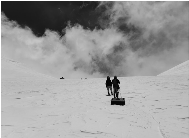
图为科考队员利用冰水情一体化雷达在东绒布冰川海拔6500米测厚 图片来源:中科院西北研究院
