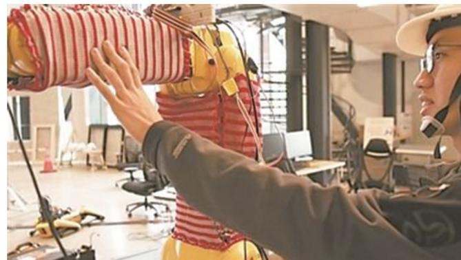
美国卡内基梅隆大学机器人研究所开发出“机器人毛衣”，这是一种可感知接触和压力的机织纺织品“皮肤”。“机器人毛衣”的针织面料由两层金属纤维制成的导电纱线组成，夹在两者之间的是网状的蕾丝图案层。当对织物施加压力时，比如有人触摸它，导电纱线会闭合电路并被传感器读取。“机器人毛衣”安装到机器人身上后，可感知接触分布、形状和力度，也比现在大多数机器人所依赖的视觉传感器更准确、更有效。
