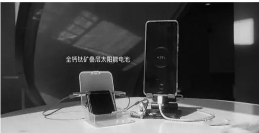
创世界纪录效率的全钙钛矿叠层太阳能电池和组件
