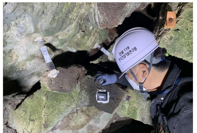
据《科技日报》报道，近日，韩国土木工程与建筑技术研究院开发了一种可检测地面或结构坍塌迹象的智能传感器和实时远程监控系统。这一设备的开发始于要寻找一种即时感应地面运动引起的斜坡或建筑物倒塌的方法，以便立即作出反应。该传感器在检测到地面运动时会打开LED警告灯。
