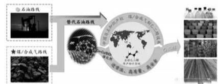
富勒烯改性铜催化煤/合成气常压制乙二醇技术
