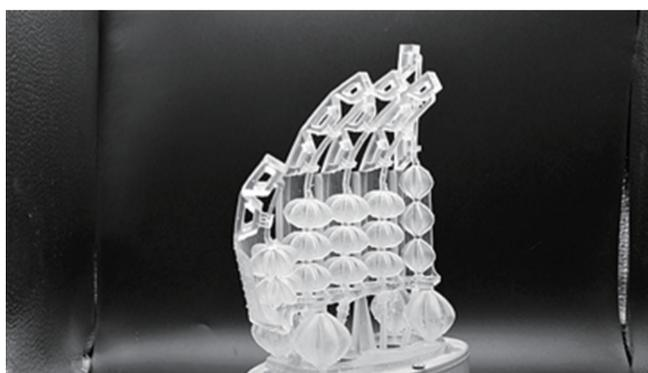
据《中国科学报》报道,意大利研究人员近日设计制造了一种由3D打印结构组成的人造气动肌肉,其可根据需要伸展和收缩。这是一种在单一打印过程中制造、由18种不同的能够收缩和拉长的执行器组成的气动手。
