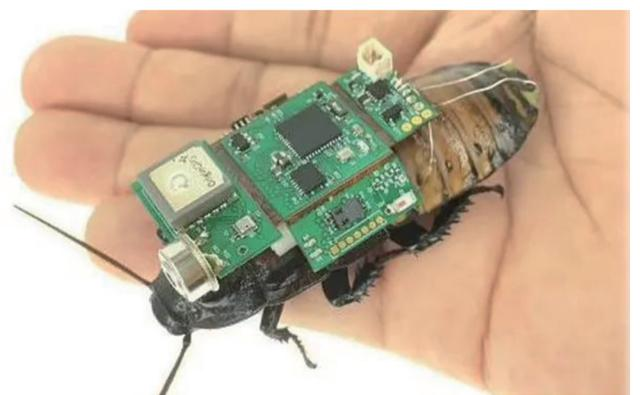
据《光明日报》报道,近日,日本理研先锋研究中心研究人员领导的一个国际团队设计了一种远程控制的半机械蟑螂系统,该系统配备了一个微型无线控制模块,可通过太阳能电池供电。尽管有机机械装置,但超薄的电子设备和柔性材料允许昆虫自由移动。
